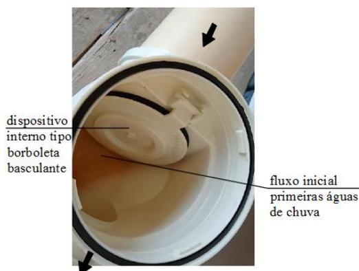
**Figura 6:** Teste de bancada do dispositivo interno tipo borboleta basculante - situação inicial (Fonte: Autoria própria, 2021).
