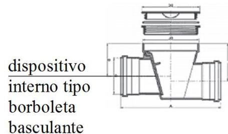
**Figura 5:** Dispositivo interno tipo borboleta basculante-corte desenho técnico (Fonte: Tigre, 2010).
